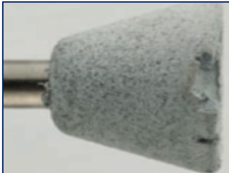
Fresa de pulido con desprendimiento de material en el extremo distal
